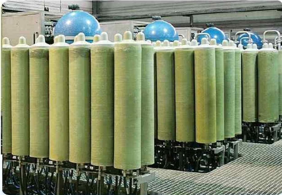
碟管式反渗透是反渗透的一种形式，是专门用来处理高浓度污水的膜组件，DT组件操作压力具有75bar、150bar、200bar三个等级可选，处理对象涉及到垃圾填埋场渗滤液、垃圾堆肥场渗滤液处理。针对这一特性，我公司研发部自行研制开发了**Windor** DTRO（碟管式反渗透）玻璃钢耐压外壳即DTRO外部组件。
